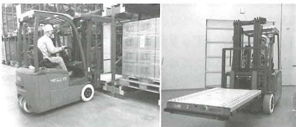
写真.4 必要間口へシャトルを移動させる様子
