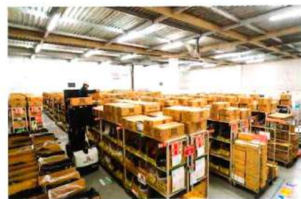
ハイビックランナーの導入で、フォークリフトに比べてピッキングの体感スピードが4倍にアップ。脚立が不要となり、安全性も増したと女性パートタイマーにも好評。リポリューションファンは3年前に別のセンターで導入。評判がよいのでここでも使うことに。
