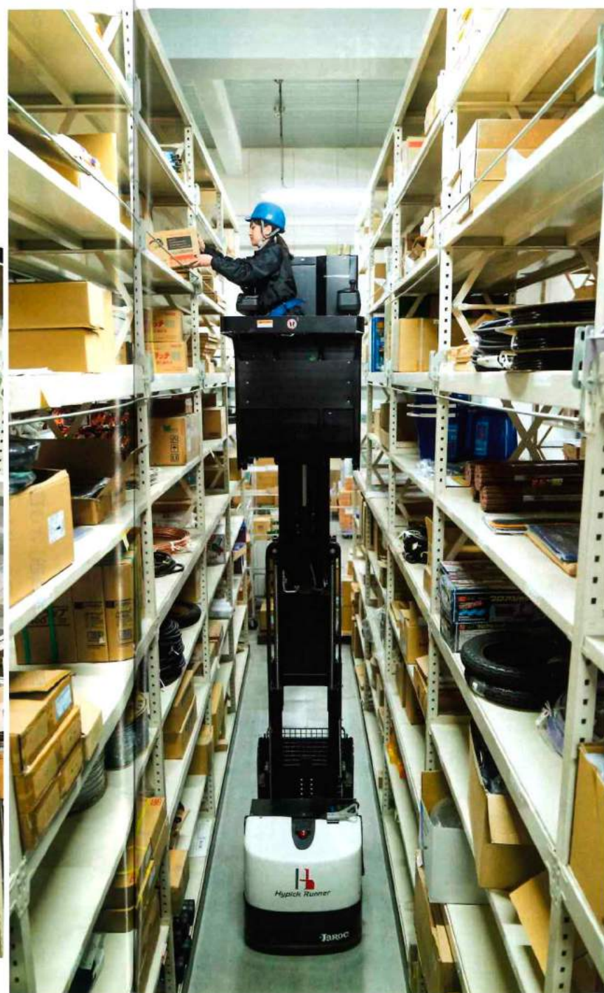
フォークリフトで荷捌きするには、パレットの出し入れや車体の旋回に最低3mほどの通路幅が必要。積み荷から商品やケースを取り出す場合も、その都度パレットごと上げ下げすることになり、効率性や保管スペースの面で課題があった。ハイビックランナーの活用で左のように改善。
