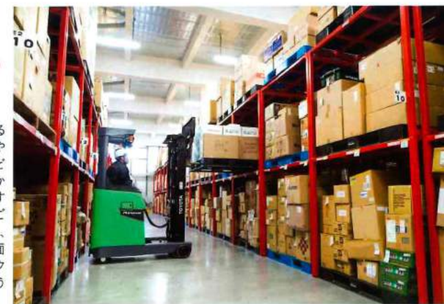
フォークリフトで荷捌きするには、パレットの出し入れや車体の旋回に最低3mほどの通路幅が必要。積み荷から商品やケースを取り出す場合も、その都度パレットごと上げ下げすることになり、効率性や保管スペースの面で課題があった。ハイビックランナーの活用で左のように改善。
