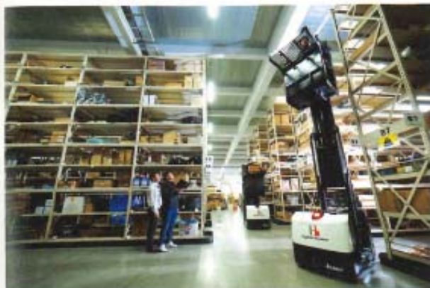
ジャロックが販売する高所作業に対応した電動ピッキングカー。女性でも簡単に扱える
