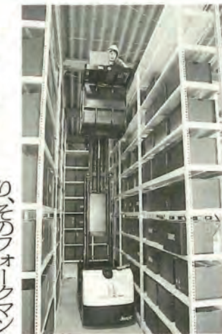
「ハイビックランナー」で高層中量ラックを最大限に活用
